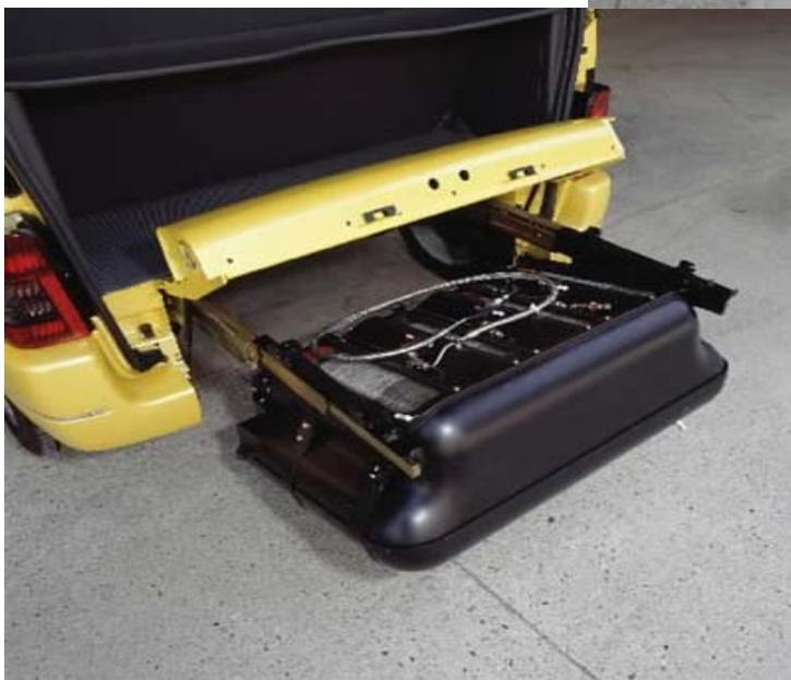
Le réservoir d'hydrogène est réalisé sous la forme d'un rack interchangeable.
