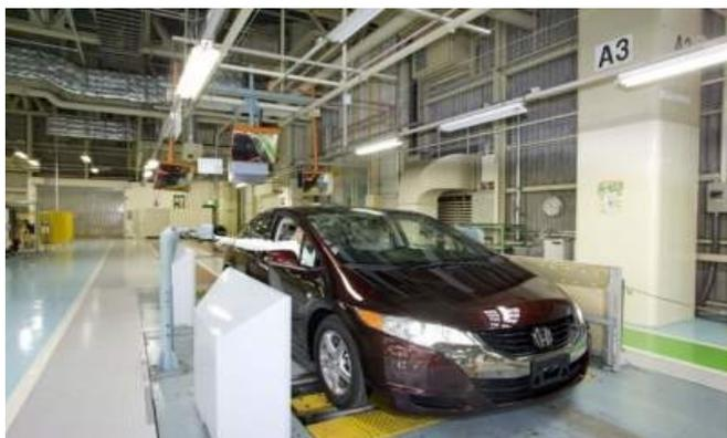
FCX Clarity, berline 5 places Honda , 134 ch, 256 Nm, un réservoir de 4 kg d'hydrogène à 350 bars, pour une autonomie de 435 km et une vitesse de pointe de 160 Km/h. Au tarif de 600 dollars par mois sur trois ans (21 600 \$ ou 14 718 € aujourd'hui).
