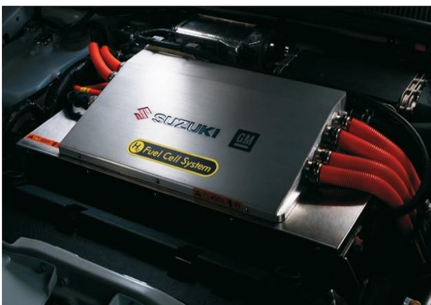
**Suzuki SX4-FCV** à pile à combustible présenté au Mondial 2008 à Paris. Développé en collaboration avec GM. Hydrogène à 700 bars pour une autonomie de 520 km. Puissance disponible 80 kW.
